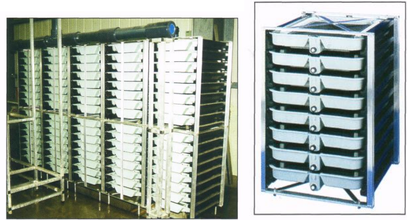
Рис. 23. Вертикальные инкубационные шкафы
